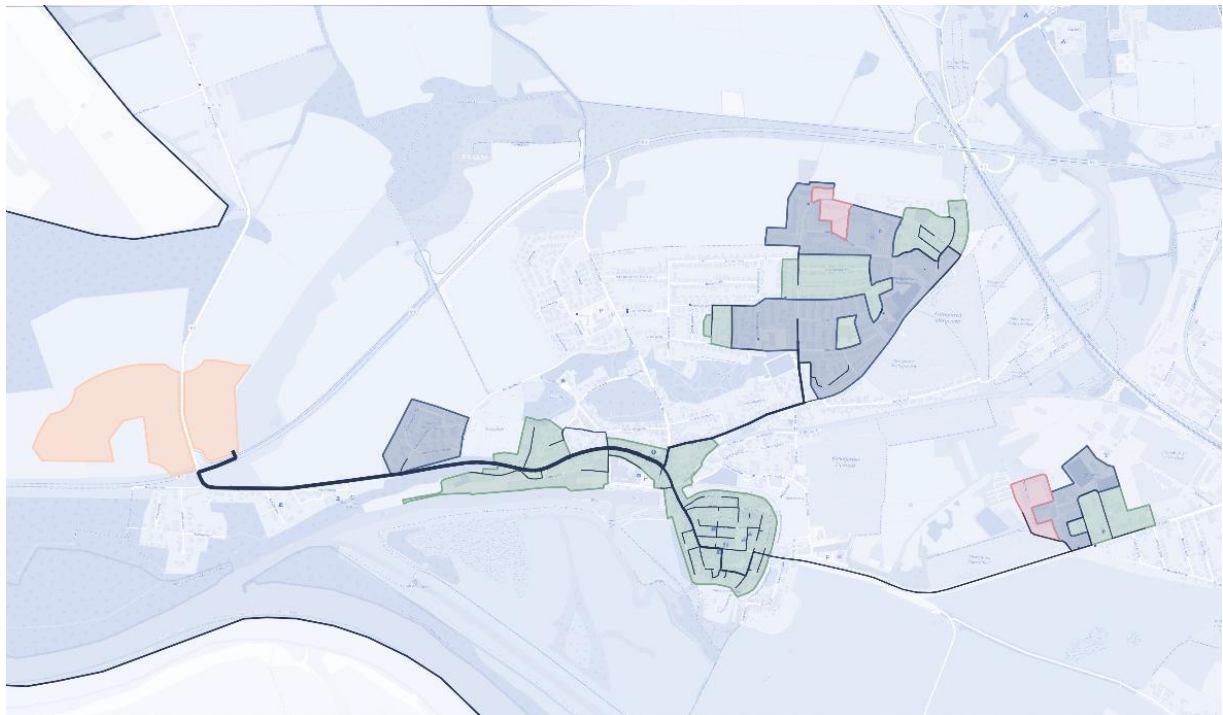
Abbildung 7-7: Möglicher Fernwärme-Netzausbau für Erzeugerpark 1 und Erzeugerpark 2
